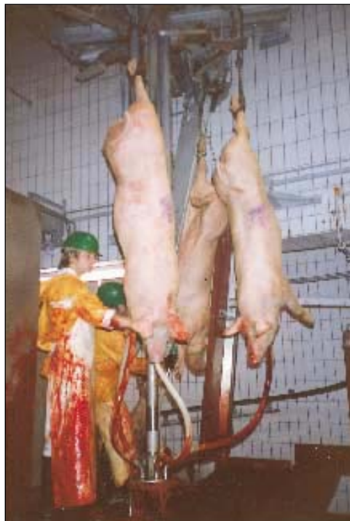
Stickning vid ett schweiziskt slakteri som använder högspänningsbedövning. Kramperna vid el-bedövning medför risk för personalen under stickning och bloduppsamling.
